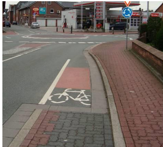
Abbildung 102: Beispiel - Radverkehrsführung an Kreisverkehren
