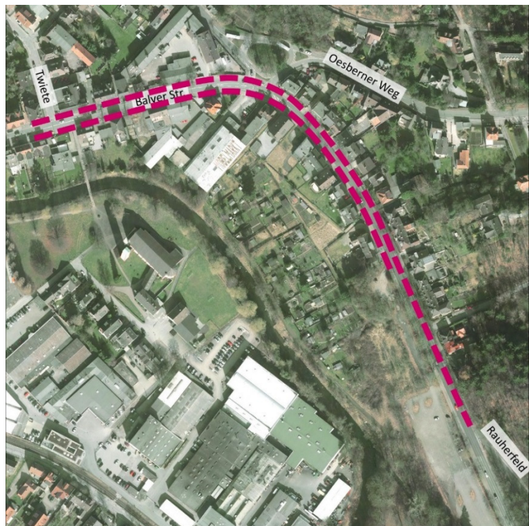
Balver Straße - Lage der geplanten Schutzstreifen
